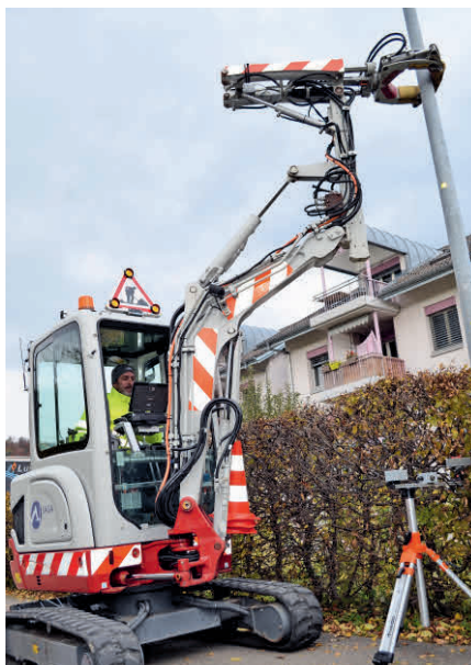
Pascal Schneider von der Firma Saga führt eine Standfestigkeitsprüfung an einer Lampe durch.
